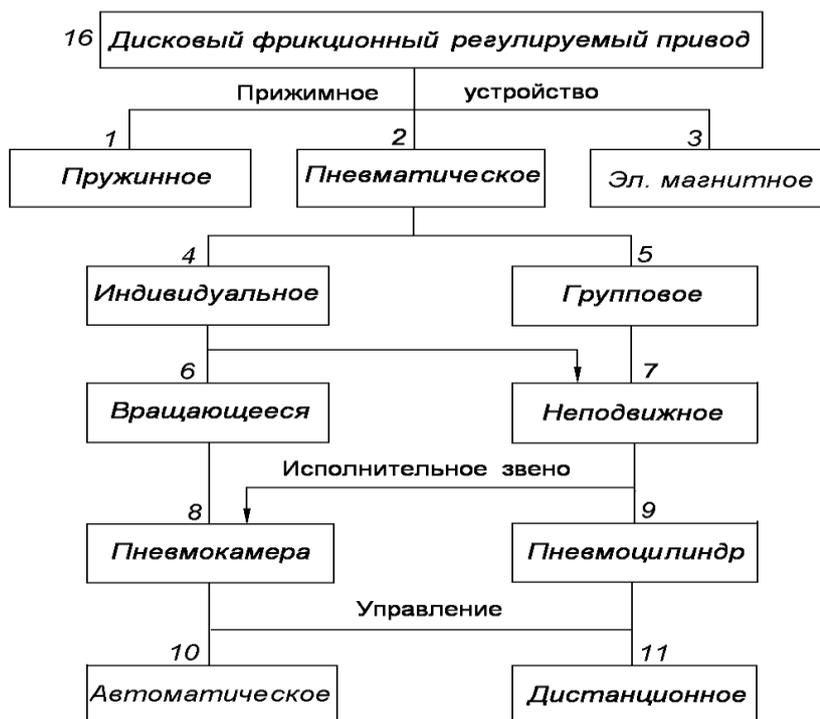
Рисунок 4.5– Классификация дисковых фрикционных регулируемых приводов
